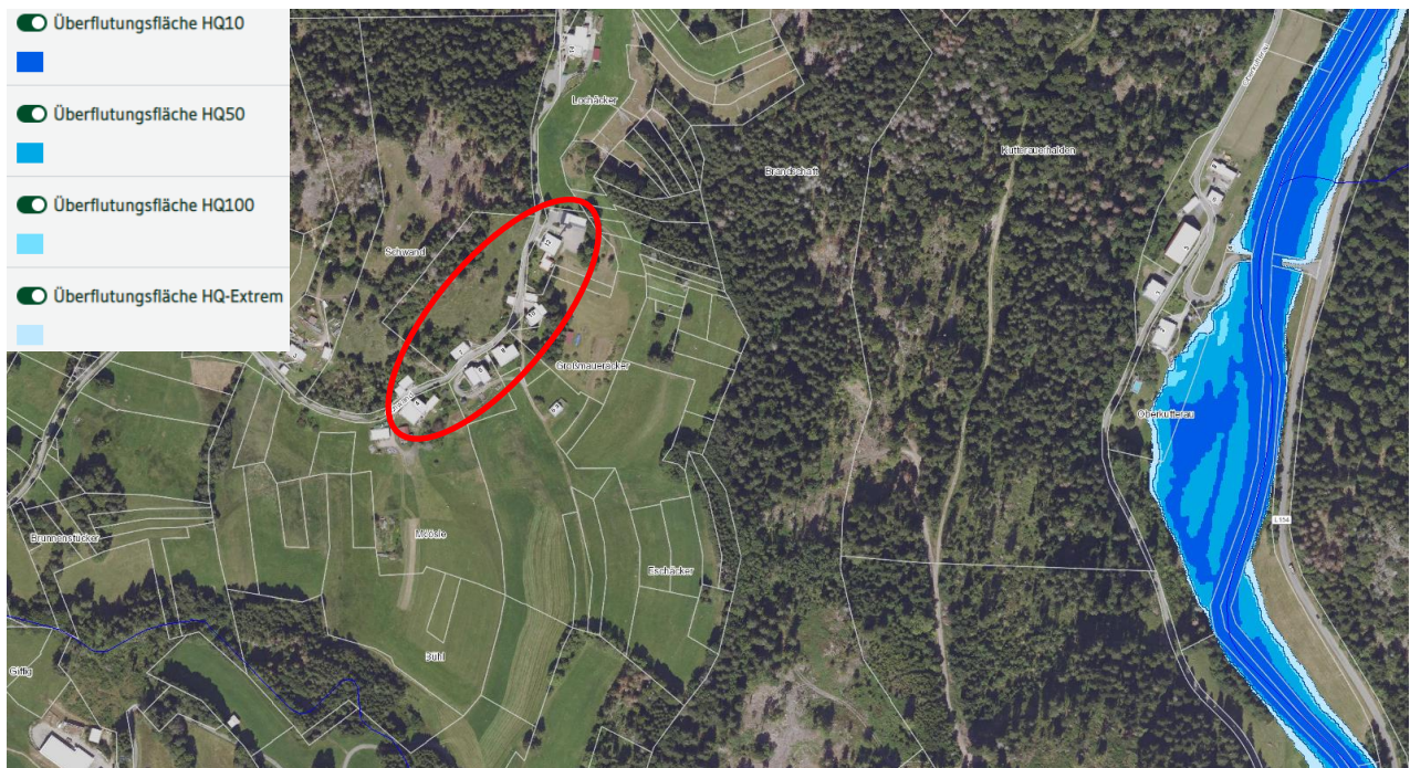
Abbildung 13: Plangebiet (rot), Fließgewässer (blau), Überflutungsflächen an der Hauensteiner Alb (Blautöne) (Quelle: LUBW)
