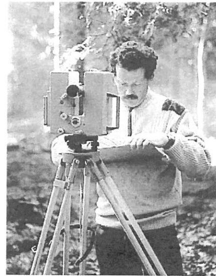
Vermessungstechniker Walter Stoll vom Flurneuordnungsamt Bad Säckingen ermittelte mit einem elektronischen Tachymeter die höchste Stelle des Dachsbergs.
